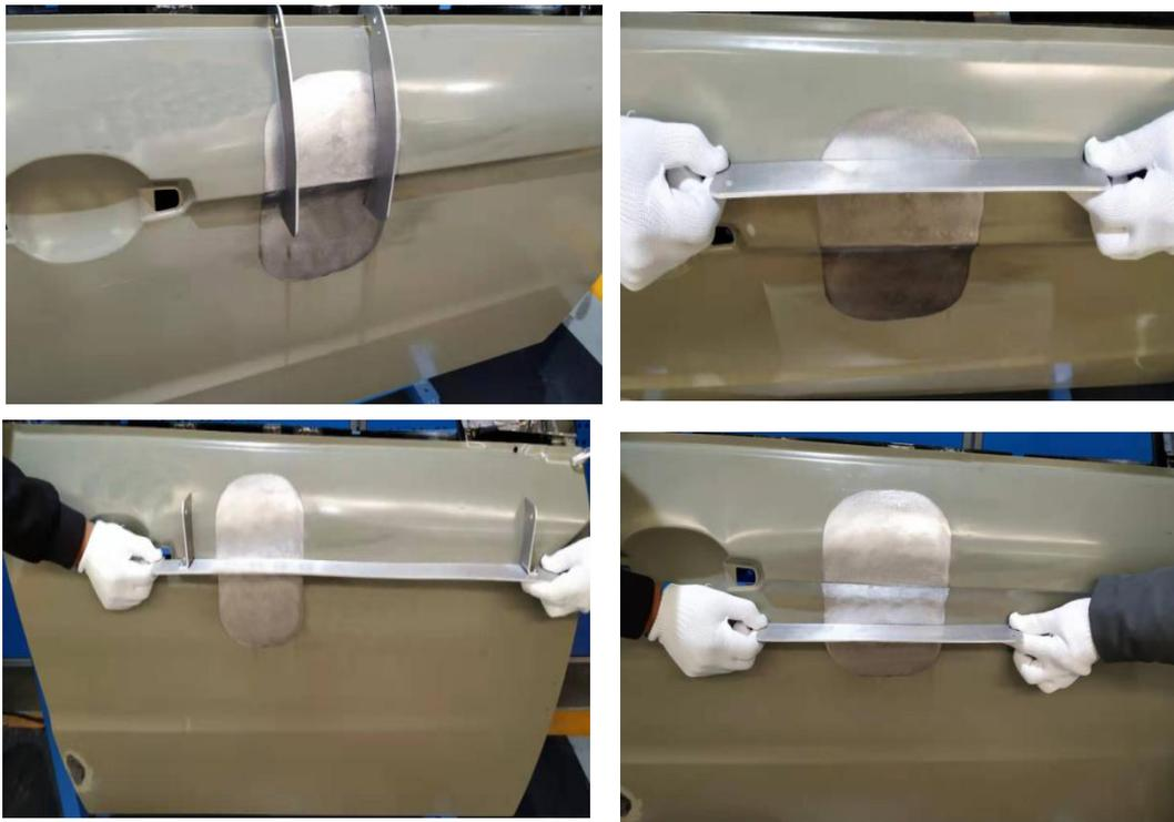
选手对凹陷部位分析、打磨、合理使用工具及设备，按正确工艺进行损伤修复。
